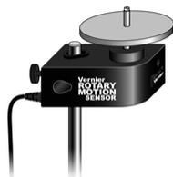
*Étape 2.* Ajustez le temps d'acquisition à 10 secondes. Faites tourner très rapidement et débutez l'acquisition de données. Observez comment la vitesse angulaire diminue graduellement avec le temps.
