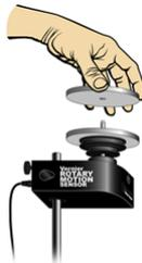
*Étape 4.* Faites tourner le premier disque rapidement et débutez l'acquisition. Après quelques seconds, laissez tomber le second disque sur le premier et observez les changements des courbes de  $\theta$  vs.  $t$  et de  $\omega$  vs.  $t$ .
